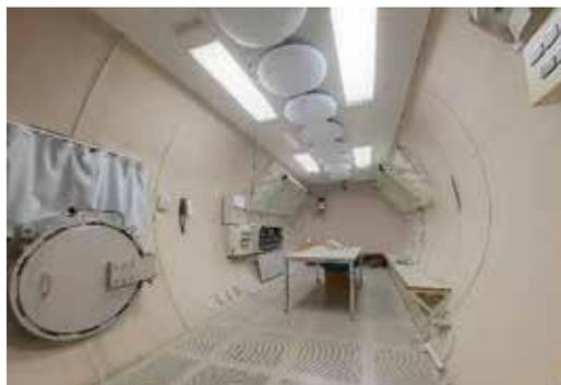
環境適応研究実験施設の低圧実験室内
